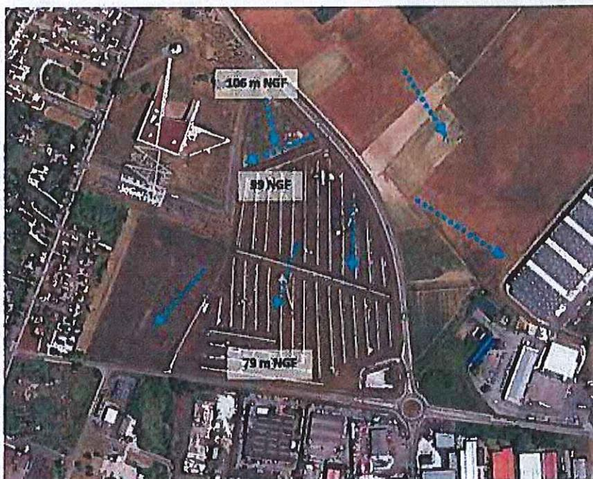
Illustration n°5 - Écoulement des eaux de surface (source : étude d'impact p.36)
